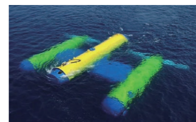
海流発電の実証機(出典:KANRIN 79号, 2018)
