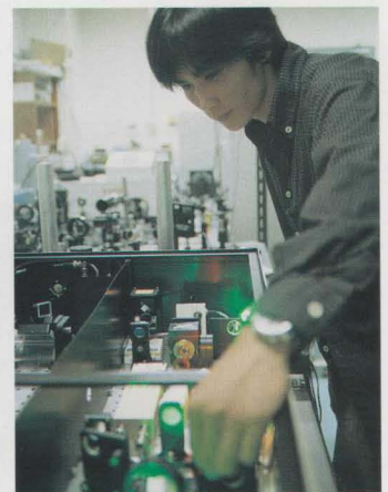
3 超短パルスレーザー装置。半導体中の励起キャリアの時間応答や光化学反応の素過程など物理現象の時間経過を詳細に追求することができる。
