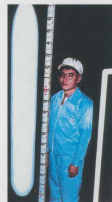
光ファイバを線引きする前段階の母材 (VAD法で合成した石英スロート)
