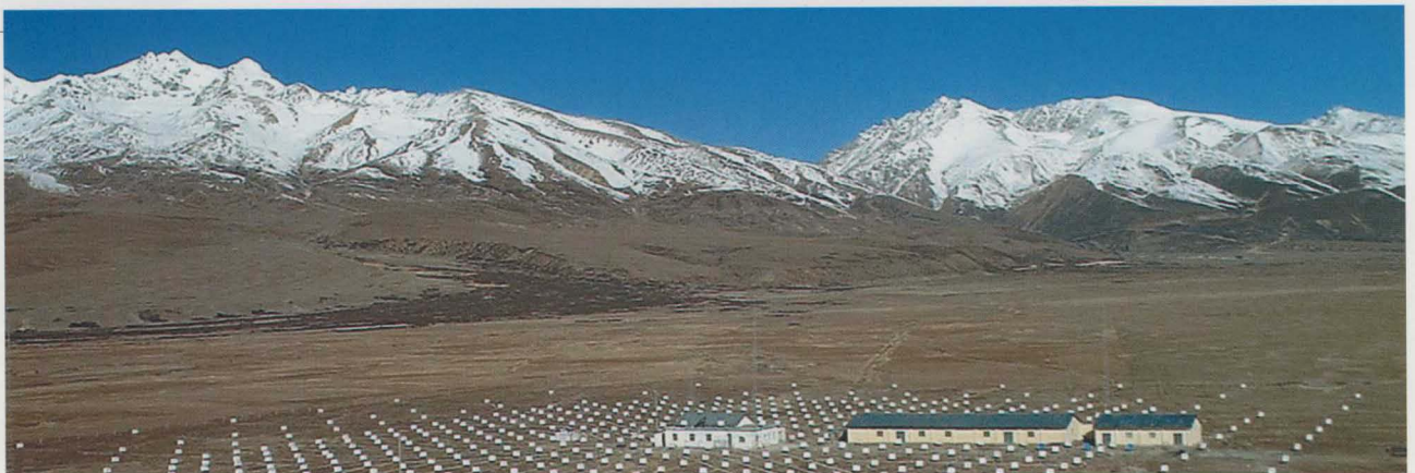
4. 日中共同研究によりチベット高原Yangbajing(標高4300m)に設置された空気シャワー観測装置。宇宙線に含まれている高エネルギー素粒子の性質を調べる。
