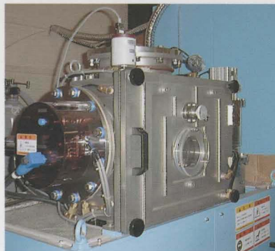
2 表面改質用PVD装置と、TiN関連の5層膜の形成例
